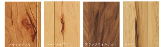
道管やその他の細胞中に堆積した炭酸塩などによって生じる暗色の筋をミネラルストリーク(鉱条)と呼ぶ。
